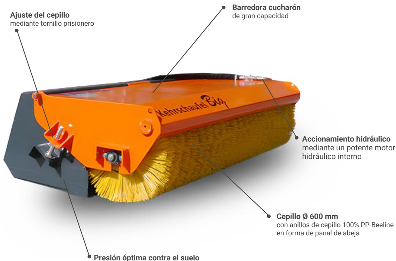
La barredora cucharón BIG está especialmente diseñada para su cargadora compacta, ideal para su mini cargadora en particular y está equipada de serie con un enganche rápido, accionado por un potente motor hidráulico con válvula de alivio de sobrepresión, que está integrado de serie en el eje del rodillo y, por lo tanto, protegido contra daños.
